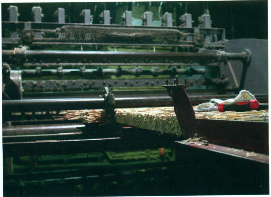
Mit einer Schilfpresse aus dem Jahr 1948 produzieren Umsiedler aus den radioaktiv verseuchten Gebieten in ihrer neuen Heimat ökologische Dämmplatten.
